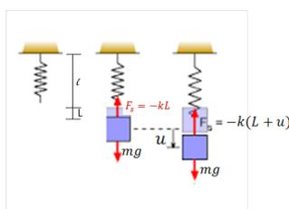
FIGURE 1 – Système de ressort pendu.
